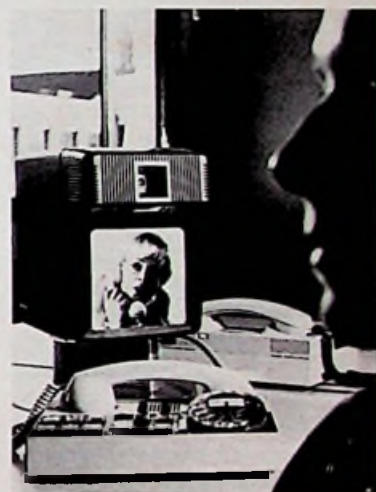
afb. 15. De thans in een proefnet opgenomen beeldtelefoon van Siemens de Videoset 101. (1971).
