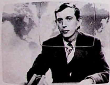
afb. 11. Het door de beeldtelefoon uitgezonden beeld, in verhouding tot een normaal televisiebeeld. De beeldoplossing blijft gelijkwaardig ondanks het verschil in bandbreedte, resp. 1,3 MHz en 5 MHz.
