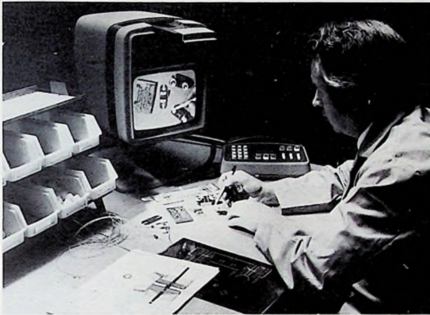
afb. 8. De beeldtelefoon neemt via de uitgeklapte spiegel (bovenaan) de daaronder liggende voorwerpen op, geeft dat beeld door aan de tegenspeler en toont het tevens aan de spreker, die voorwerpen aanwijst met zijn balpoint. (foto Philips)
